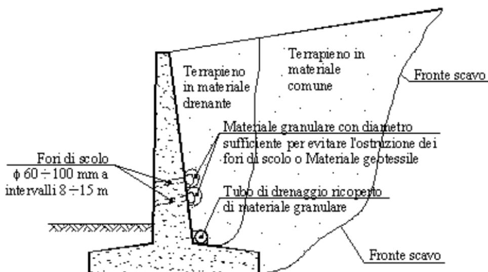
Particolare attenzione deve essere posta nell'esecuzione di muri realizzati in zone con temperature rigide, dato che l'acqua, presente nel terrapieno, può gelare e produrre spinte laterali e spostamenti considerevoli, oltre i limiti di danno, e non più recuperabili quando il ghiaccio si scioglie.
