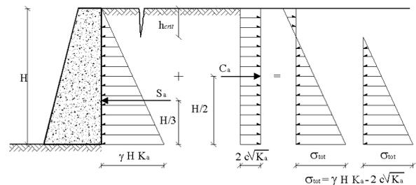
In presenza di un sovraccarico distribuito di intensità  $q$ , si considera una spinta, applicata ad  $1/2 H$ , pari a:
