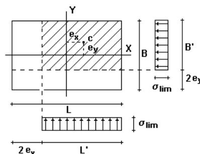
Per terreni puramente coesivi ( $\phi = 0$ ) e per verifiche di breve termine ( $c = c_u$ ), l'espressione diventa:
